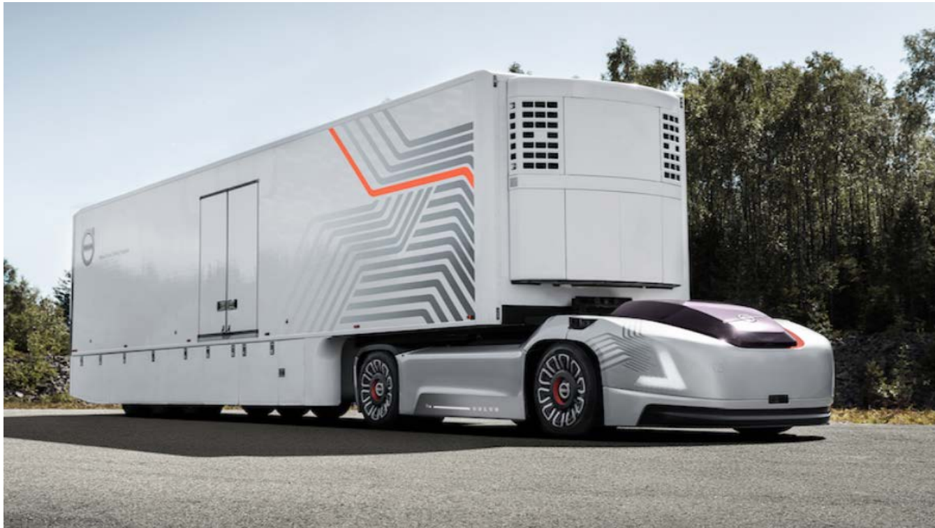
Vera von Volvo: Die elektrische, autonome Zugmaschine ist flach wie ein Sportwagen. Ein Fahrerhaus ist nicht mehr nötig.
