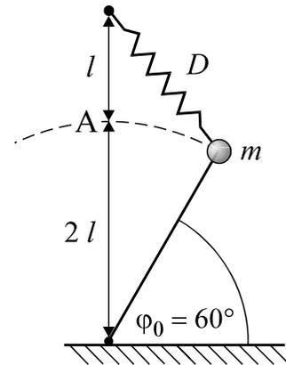
**Abb. 4.3-1** Die Kugel wird bei **gespannter Feder** los gelassen.
