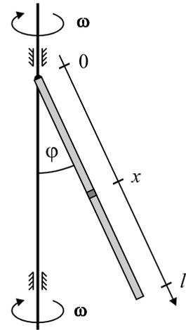
**Abb. 4.3-5** Der massive Stab ist an der rotierenden Hochachse angeschweißt.
