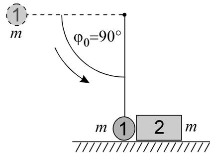
**Abb. 5.2–5** Die Pendelmasse 1 stößt zentral auf die ruhende Masse 2.
