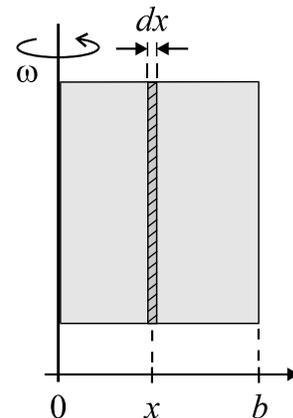
Abb. 2-2 Zuerst wird die infinitesimale Fliehkraft auf den markierten Streifen berechnet.
