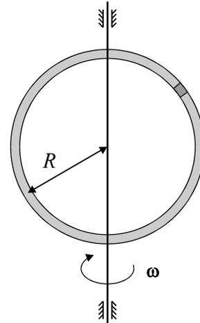
**Abb. 4.3-2** Der **dün**ne Ring rotiert mit der Winkelgeschwindigkeit  $\omega$ .
