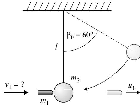
Abb. 5.2-3 Die Anfangslage und die Kugel nach dem Durchschlag sind hell und dünn gezeichnet.
