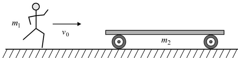
Abb. 5.2-4 Der Mann springt mit horizontaler Geschwindigkeit  $v_0$  auf den stehenden Wagen.
