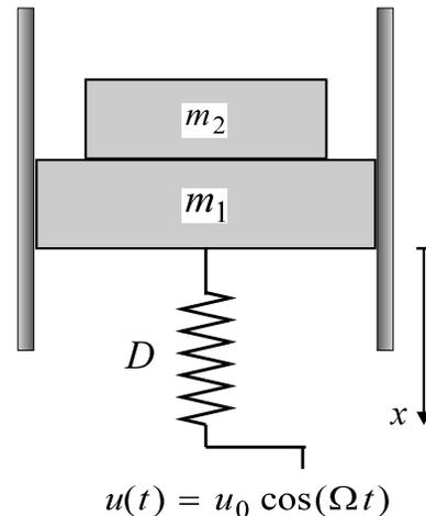
**Abb. 7.2–3** Zwei Massen schwingen reibungsfrei auf und ab. Das untere Ende der Feder wird harmonisch mit der Frequenz  $\Omega$  bewegt.
