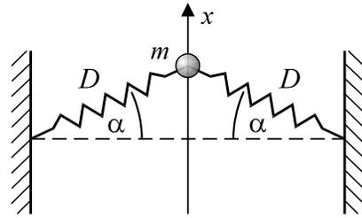
**Abb. 3.1-1** Die Masse  $m$  ruht in einer Gleichgewichtslage.
