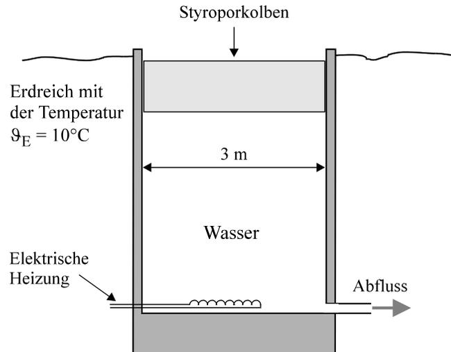
**Abb. 17.2–2** In einem Wassertank befindet sich warmes Wasser mit der Temperatur  $\vartheta_W = 50^\circ \text{C}$ . **Wärmeverluste treten nur in den vier Seitenwänden auf.** Die Wasserhöhe fällt quadratisch in der Zeit ab.
