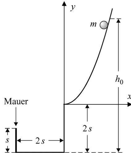
**Abb. 4.3-7** Die Kugel rutscht reibungsfrei eine Parabel hinab und soll anschließend über die Mauer fliegen.
