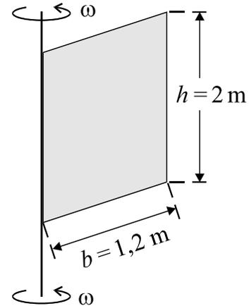
Abb. 2-1 Das dünne Brett ist an eine rotierende vertikale Achse angeklebt.
