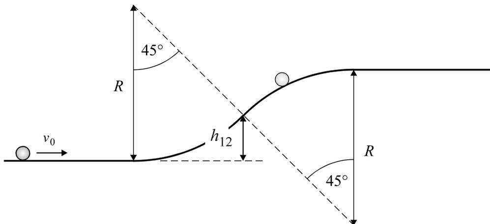
**Abb. 4.3-6** Die reibungsfrei rollende Kugel darf nicht vom Boden abheben.
