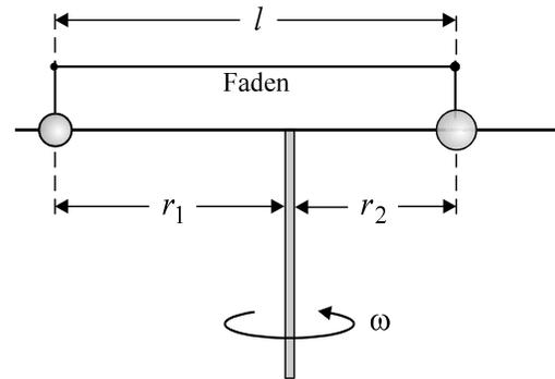
**Abb. 2-4** Die beiden Kugeln können reibungsfrei auf der rotierenden Stange gleiten, werden aber durch den Faden der Länge  $l$  zusammengehalten. Die Kugeln sollen auf Kreisbahnen laufen.
