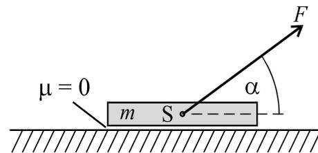
**Abb. 3.1–4** Zwischen der gezogenen Platte und dem Boden besteht keine Reibung.
