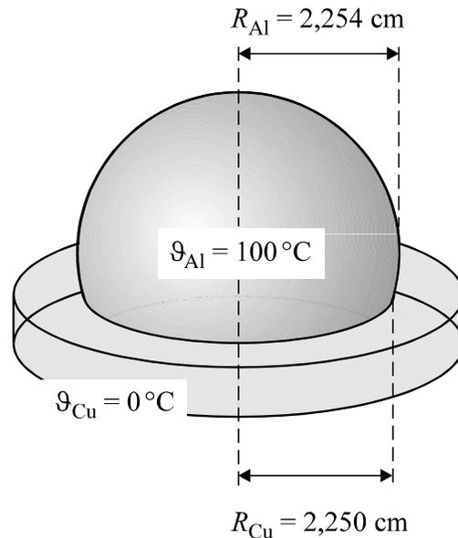
Abb. 13.1–1 Sobald sich der Temperaturengleich eingestellt hat, fällt die Alu-Kugel durch den Cu-Ring.
