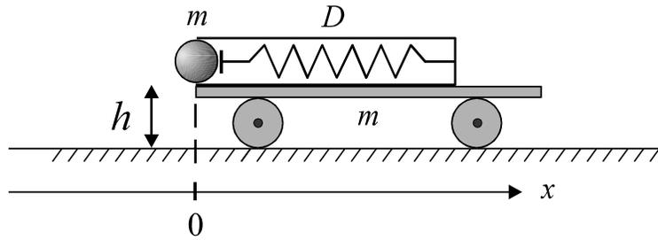
**Abb. 5.2-2** Kurze Zeit nach dem Lösen der Feder verlässt die Kugel die Federkanone an der Stelle  $x = 0$ . Dieser Augenblick, in dem die Feder die Dehnung Null hat, wird hier dargestellt.
