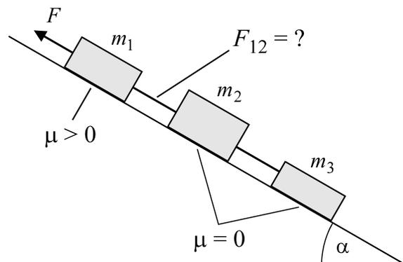
**Abb. 3.1-2** Drei Körper werden von einer konstanten Kraft hinauf gezogen. Der 2. und der 3. Körper gleiten reibungsfrei.
