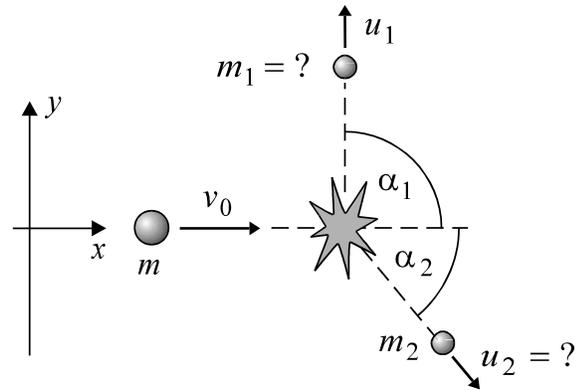
Abb. 5.2-1 Explosion einer Granate.
