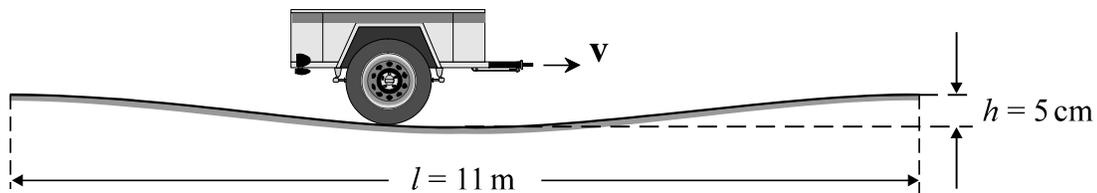
Abb. 7.2–5 Der Anhänger fährt mit ausgefallenem Stoßdämpfer ( $c = 0$ ) über eine ‘Wellblechpiste’.
