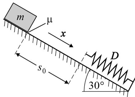
**Abb. 4.3-8** Die Masse  $m$  rutscht mit Gleitreibung den ebenen Hang hinab und drückt unten die Feder maximal um die Strecke  $s_F$  zusammen.
