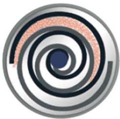
Gas tritt in die Pumpstufen ein.
