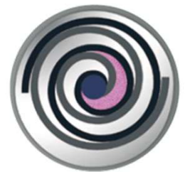
Gas wird im Zentrum der Pumpe in Richtung Auslass verdrängt.
